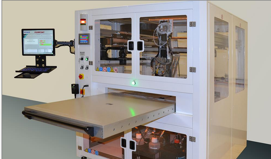
Püskürtme (Ultrasonik kaplama cihazı ile)
